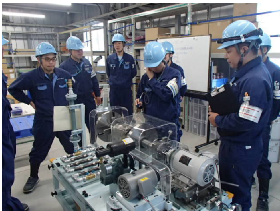
写真 回転機異常振動模擬訓練装置を使用した聴音検査実習の様子
